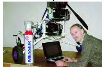
La pile à combustible fonctionne grâce à l'hydrogène et à de l'air comprimé, mais sans combustion
